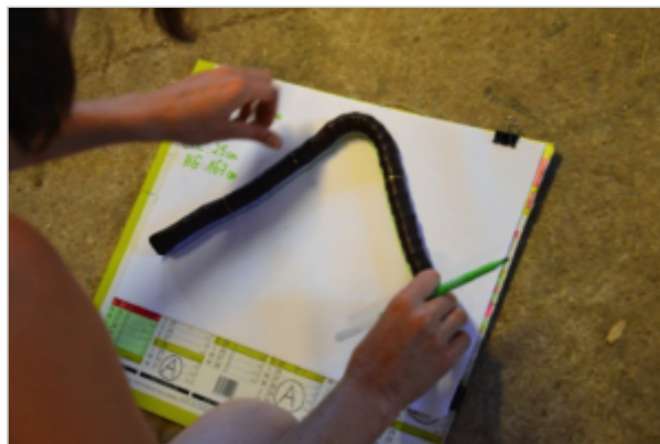
Report d'un profil relevé à l'aide d'un flexicurve
